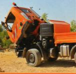
Kipp-Zugang: Wie bei großen Lkw kommt man beim U20 durch Abkippen der Fahrerkabine an die Motor- und Getriebeeinheit. Einzug der Moderne: Was im Pkw-Bereich seit geraumer Zeit Usus ist, macht auch vor Nutzfahrzeugen nicht halt. BlueTec Harnstoffeinspritzung zur Reduktion der Stickoxide.
